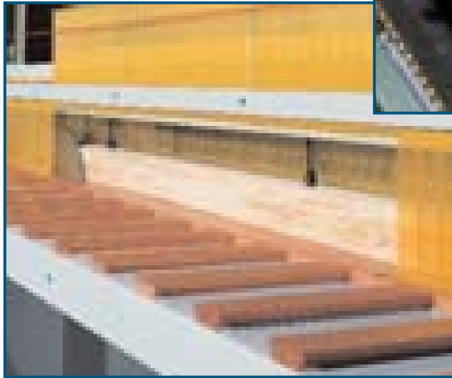
Cilindri pressori a gas (opzionale). Cylindres presseurs à gaz (option). Gas-hold-down cylinders (option). Gas-Druckzylinder (auf Anfrage).
