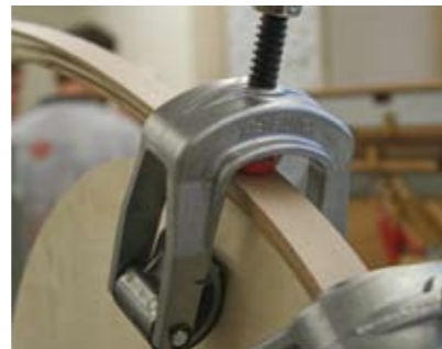
Auf Rundungen die Kanten verspannen Tauten the edges on round parts
