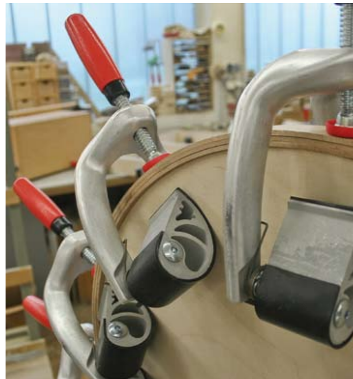
Kantenverleimungen auch bei Innen- und Außenradien möglich Glueing edges is possible for inside radii as well as for outside radii
