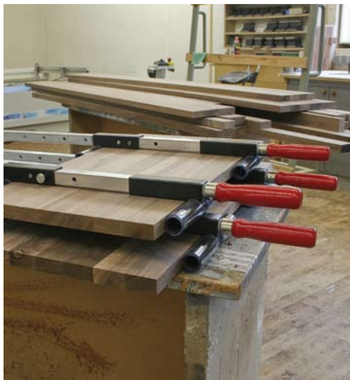
Anleimen von Kanten oder Friesen an flächigen Teilen Glueing on edges or cabinets on laminar parts
