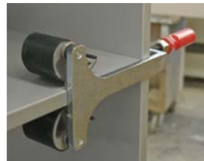
Verleimen von Zwischenwänden
