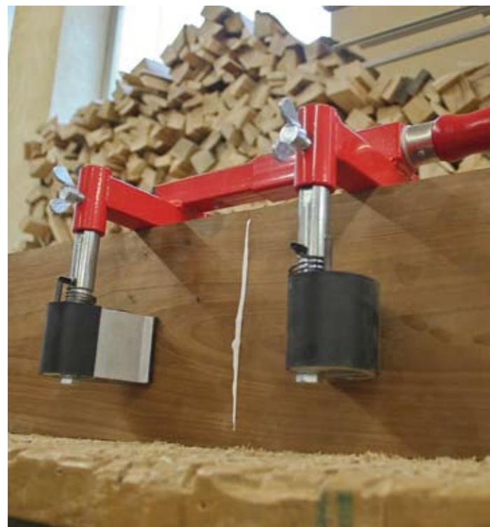
Längsverleimung von Plattenstößen
